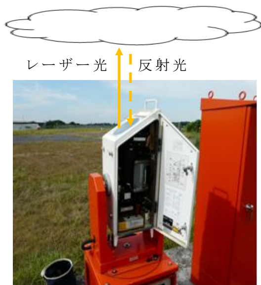
写真 3 シーロメーターの内部とレーザー光での測定
